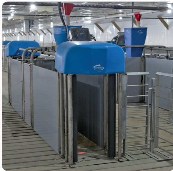
ЕЛЕКТРОННІ СТАНЦІЇ ГОДІВЛІ ДОЗВОЛЯЮТЬ ОЦІНИТИ РІВНІ ІНДИВІДУАЛЬНОГО СПОЖИВАННЯ КОРМУ
